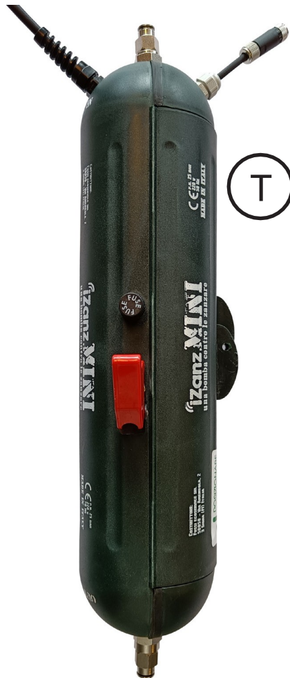
Figura 2 - Zona "T": identificazione targhetta marcatura CE
