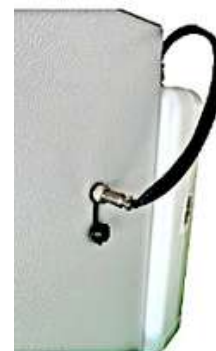
Figura 5 - Collegamento del galleggiante della tanica al connettore della centralina (DX)
