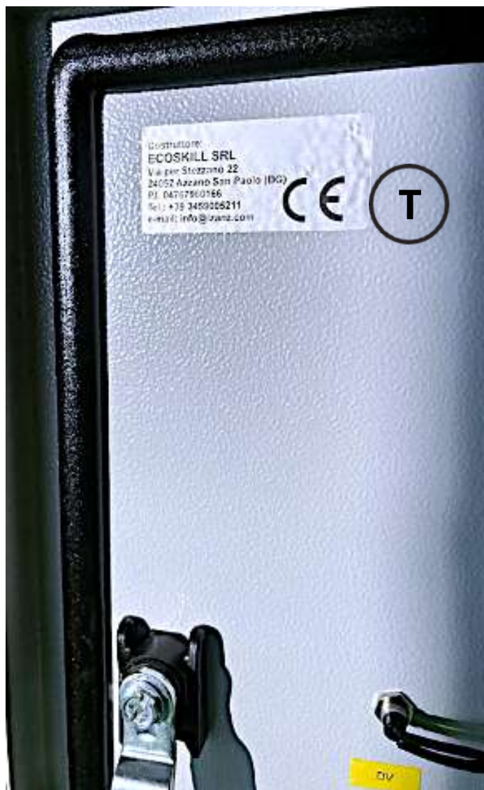
Figura 2 - Zona "T": identificazione targhetta marcatura CE
