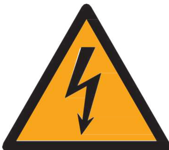
Segnaletica pericolo rischio elettrico
